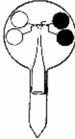
Trata-se de um dispositivo denominado “radiômetro de Crookes”, constituído de uma série de palhetas dispostas em uma espécie de hélice, dentro de um bulbo de vidro em que existe um gás à baixa densidade. As palhetas (polidas de um lado e enegrecidas do outro) põem-se a girar quando incide energia radiante no dispositivo. Isso se dá porque
